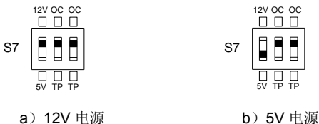
图 3-23 开路集电极输出型编码器 S7 拨码方式
