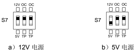
图 3-25 推挽输出型编码器 S7 拨码方式
