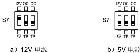
图 3-27 差分输出型编码器 S7 拨码方式
