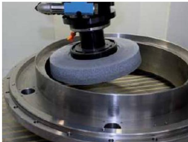
立式磨床典型的可加工工件如：风电，轴承，齿轮，法兰等。
