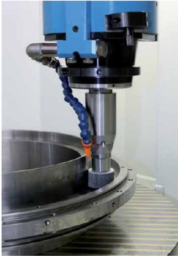
立式磨床例如对于 0.2mm 斜面的加工，仅可调整主轴角度即可。立式主轴磨床可批量加工高精度工件，可磨削凸轮形状和其它复杂型面的工件。
