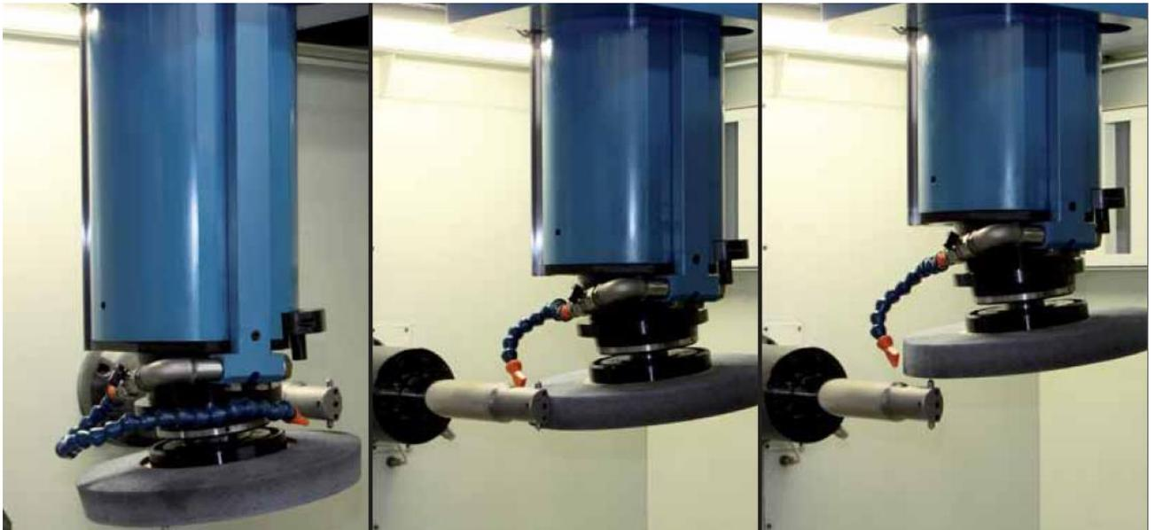
立式磨床的结构小巧，紧凑和简洁但可对较大的工件进行内外圆、端面等进行磨削加工。砂轮主轴可手动调节角度，从而可对内外圆进行切线方向磨削，而不需要对工件重新装夹，节省了时间和提高了定位精度。
