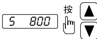
图 7.9 速度试运行操作框图
