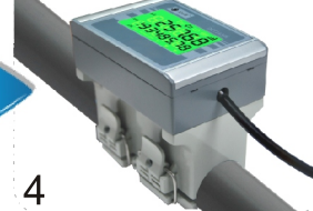
安装完成，开始测流量
