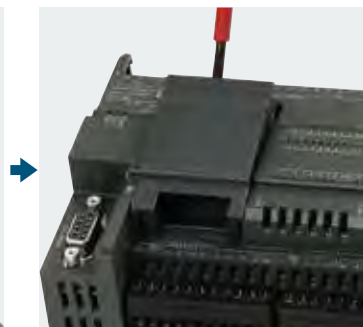
用螺丝刀卸掉空盖板
