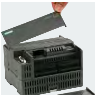
卸掉端子盖板
