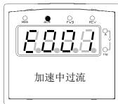
图 4-4 故障告警显示状态
