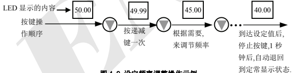
图 4-8 设定频率调整操作示例
