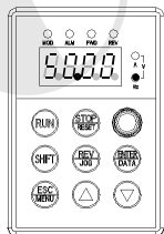
图 c 运行状态，显示 运行状态参数
