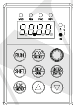
图 b 待机状态，显示 待机状态参数
