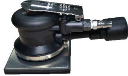
四角型三合一打磨机 订货号: HR4022 底盘大小: 110X100mm 吸尘孔数: 8孔 震动轨迹: 5mm 震动频率: 10000b. p. m 耗气大小: 200升/分钟 磨机重量: 0.82公斤
