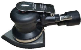
三角型三合一打磨机 订货号: HR4014 底盘大小: 125X95mm 吸尘孔数: 8孔 震动轨迹: 5mm 震动频率: 10000b. p. m 耗气大小: 200升/分钟 磨机重量: 0.82公斤
