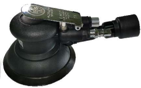
5寸中央集尘中磨机 订货号: HR4112V 底盘直径: 125mm/6孔 偏心大小: 5mm 耗气大小: 200升/分钟 空转转速: 11000r. p. m 磨机重量: 0.82公斤
