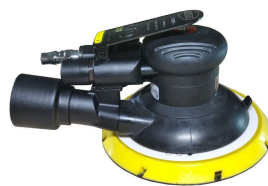
6寸静音型小偏心精细磨机 订货号: HR8101V 底盘直径: 150mm/15孔 偏心大小: 2.5mm 耗气大小: 60升/分钟 空转转速: 12000r. p. m 磨机重量: 0.73公斤 底漆打磨, 及超精细平面打磨
