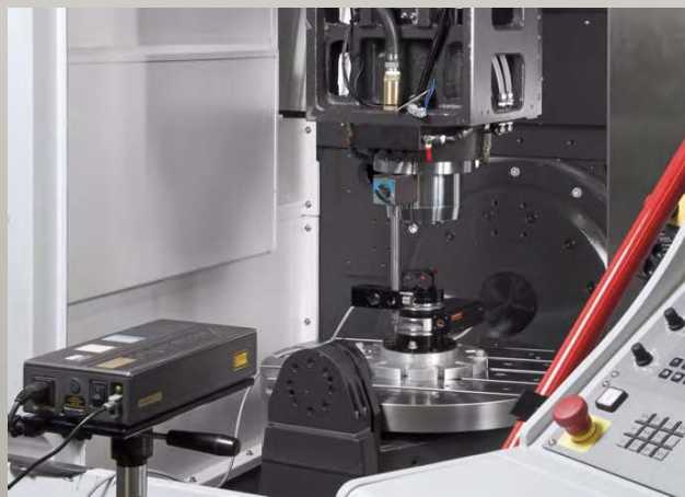
旋轉軸雷射精度檢測
