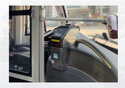
嵌入式智能投币机,是在智能投币机识别防盗等功能的基础上进行了高度集成、减小体积,融入扫码支付,现金识别、计数、自动堆叠,自动智慧语音提示,GPS定位等功能,挂载4G通讯网络,依托健全的物联网管理系统和精准的客流统计系统有效的帮助公交公司管理升级的最新一款智能化投币机。
